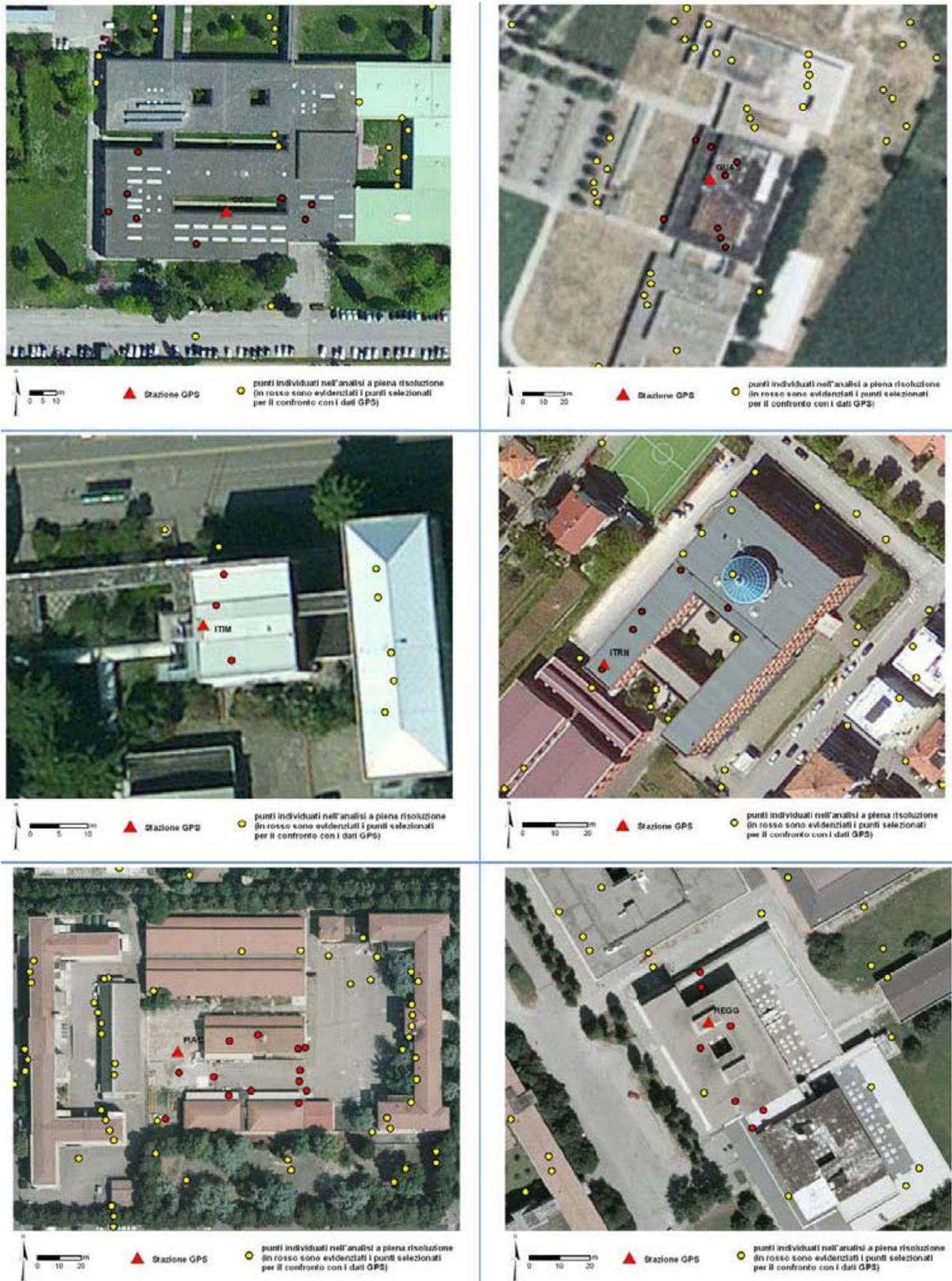
*Fig. 7 - Distribuzione dei punti di misura individuati nell'analisi SqueeSAR™ a piena risoluzione nell'intorno delle 6 stazioni GPS; sono evidenziati in rosso i punti di misura selezionati per il confronto con i dati GPS*
